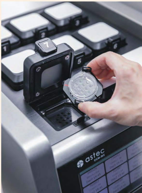
▲ 將受精完成的胚胎放入 Time-lapse，觀察胚胎發育的動態變化
